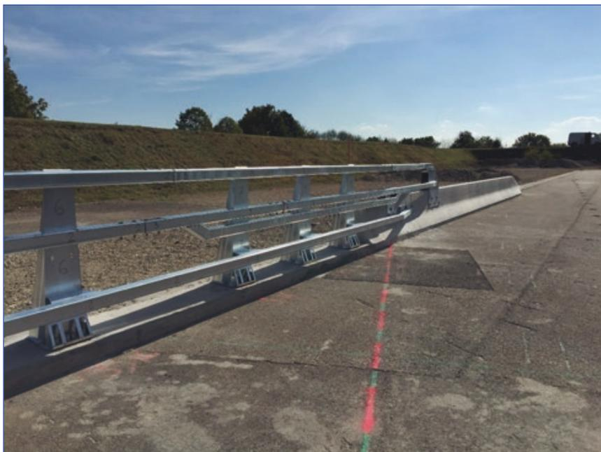
Foto 3. Ensayo a escala real de transición entre barrera rígida de hormigón y pretil metálico, evaluado según la Norma NF058<sup>(VIII)</sup>.
